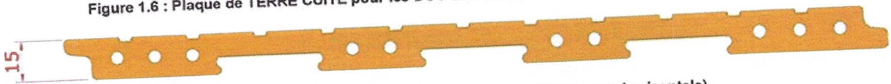
Figure 1.7 : Plaque de TERRE CUITE pour les DUO BRICK'HELIUM (coupe horizontale)
